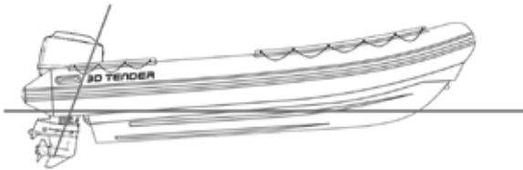
L'avant du bateau déjaugé, trop de trim positif
